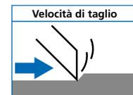
La velocità di taglio è la velocità alla quale il tagliente dell'utensile viene portato a contatto con il materiale da lavorare in direzione di
