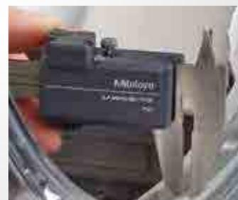
**U-WAVE-T per strumenti di misura vari**
