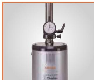
Calibrazione con comparatore di tipo analogico
