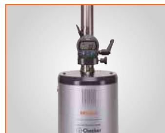
Calibrazione con comparatore di tipo digitale
