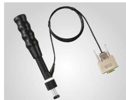
Dispositivo di impatto HLDL UD-414 Per denti degli ingranaggi, angoli saldati, ecc.
